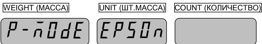
Эти весы поддерживают работу со следующими моделями принтеров: EPSON PRINTER, CAS DEP50, CASDLP50. Выводимые на печать штрих-коды: EAN13, EAN8, CODE39, UPC-A (только принтер модели DLP50).
