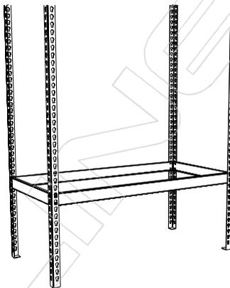
**Рис.2** Сборка каркаса полки
