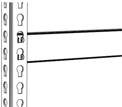
**Рис.1** Сборка стойки и стяжки
